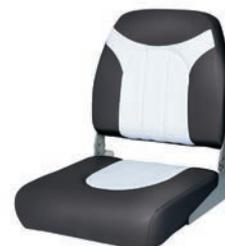
Das Innenleben des Sitzes besteht aus einem Kunststoffkern, überzogen mit einem druckfesten Schaum, der in Form bleibt. Der besonders solide und seewasserbeständige Vinylüberzug ist schimmel- und UV beständig. Die Scharniere der Rückenlehne sind aus korrosionsbeständigem Aluminium. Ein Sitz mit hervorragendem Komfort.
