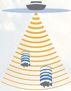
**GRUNDLEGENDES:** Fishfinder senden hochpräzise Ultraschall-impulse ins Wasser. Objekte unter Wasser (Fische, Strukturen, Algen, Grund) reflektieren diese zurück zum Geber und dann zum Gerät, das diese Echos anzeigt.
