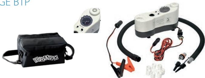
Elektrische Luftpumpe mit Auto-Stop wenn eingestellter Druck erreicht ist. Luftfilter, leicht zu reinigen und auszutauschen. Lieferumfang: Tragetasche, Adapter auch für Schlauchboote, Stromkabel für Zigarettenanzünder, Froschklemmen, Manometer, 1,7 m Luftschlauch und 3m Kabel. Kann aufblasen und entleeren. Stromverbrauch 20 A.
