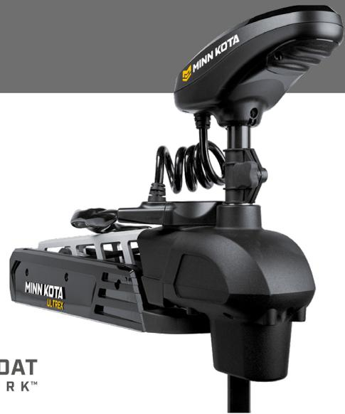
ULTREX ist der erste Bugmotor mit Kabel-Fußlenkung (Bowdenzug) der mit den auf GPS basierenden Steuersystemen i-Pilot oder i-Pilot Link kombiniert wurde. So mancher Bootsfischer, der hauptsächlich stehend im Boot angelt, bevorzugt eine Kabel-Fußlenkung, da Kehrtwendungen bei diesen Motoren etwas schneller als rein elektrisch zu bewerkstelligen sind. Mit dem ULTREX ist nun auch diese Steuervariante mit der Welt von i-Pilot und i-Pilot Link verbunden!
