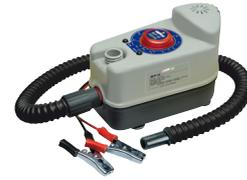
Elektrische 12 Volt Luftpumpe welche variabel bis zu max. 1 bar eingestellt werden kann. Sie stoppt bei Erreichen des gewünschten Drucks automatisch. Sie hat eine Leistung von 160l/min und wird inkl. Adapter, Schultertasche, Schlauch und Froschklemmen geliefert.
