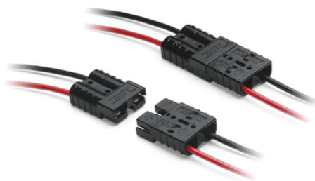
Steckverbindung mit Einrastverriegelung, für Kabel mit Querschnitt bis 4-16 mm<sup>2</sup>. Der Satz besteht aus 2 Steckerhälften, 4 Kontakten und 4 Lötpins, um die Kabel in den Kontakten zu sichern. Kabel sind im Lieferumfang nicht enthalten. **90 1245**
