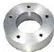
**5-Loch Distanzflansch aus Aluminium** mit Innengewinde 1 1/4" und 5 Schraubenlöcher für M5, passend zu Tauchrohrgeber S5, speziell auch für Aluminiumtanks **70 0204**
