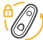
**Lenksperre:** Wenn sie den Fuß vom Ultrex- Fußpedal nehmen, bleibt der Motorkopf in die Richtung gerichtet, in die Sie ihn verlassen haben.
