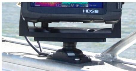
Drei-Achsen Plattform zur Montage von Fischfinder und Kartenplotter. Der dreiteilige Achsenaufsatz hat oben und unten Gelenke mit arretierbaren R-Lock-Verschlüssen, die zum Patent angemeldet sind. Das Mittelgelenk ist in 15-Grad Schritten einstellbar. Die Plattform hält Geräte bis 1,50 kg.
