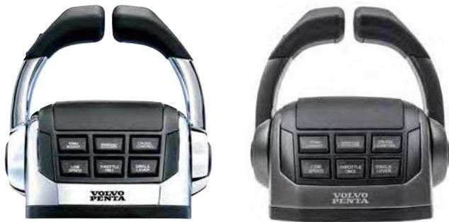
Top-montierte EVC-Bedienelemente, Doppelanlage
