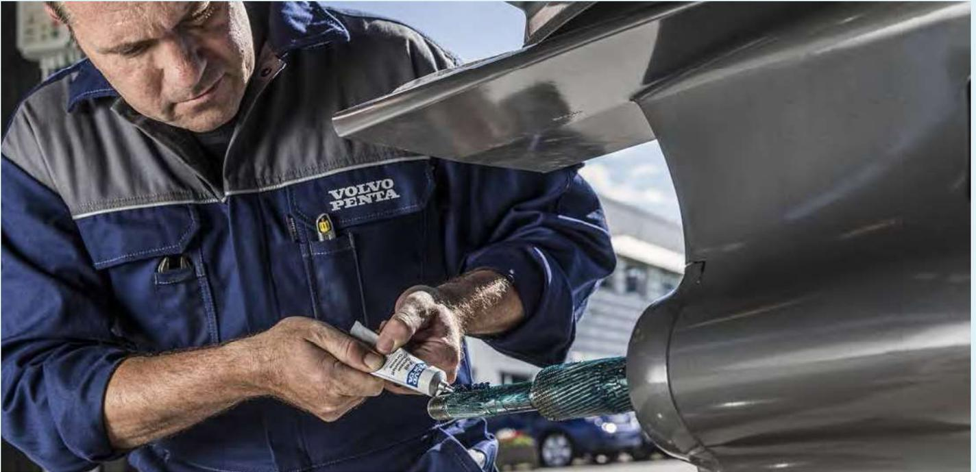
**Schmieren Sie nach.** Die Propellerwelle sollte mindestens einmal jährlich sowie beim Propellerwechsel gereinigt und nachgeschmiert werden. Regelmäßige Schmierung verhindert das Festkleben des Propellers an der Propellerwelle. Sehen Sie in der Bedienungsanleitung die empfohlenen Intervalle nach.
