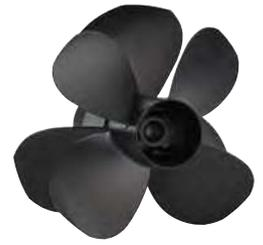
**Hinweis!** Verwenden Sie immer Propeller aus Edelstahl des Typs F oder FH in Motoren mit einer Leistung über 240 PS oder mit einer Geschwindigkeit über 38 Knoten (45 mph), Siehe nächste Seite.
