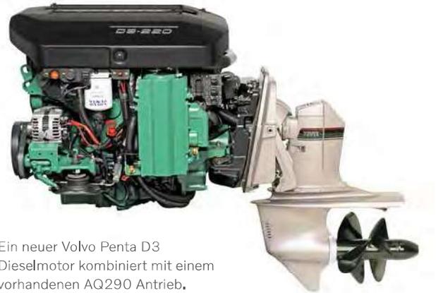
Ein neuer Volvo Penta D3 Dieselmotor kombiniert mit einem vorhandenen AQ290 Antrieb.
